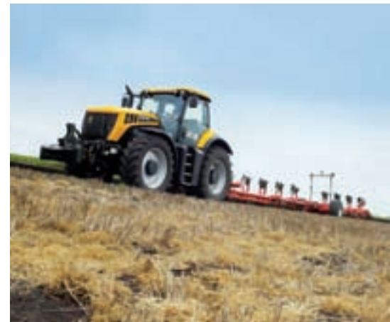
8310: un tracteur qui allie confort, vitesse et productivité. La suspension intégrale assure une excellente traction. La transmission CVT est facile d'usage, efficace et avec les freins ABS permet de rouler jusqu'à 70 km/h.
