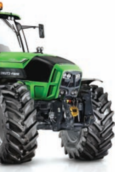
7250 TTV: tracteur de l'année 2013 en Europe. Très bonne efficacité et confort grâce à la transmission CVT ZF et le moteur Deutz Tier4i SCR. Cabine avec excellente visibilité, confort et ergonomie. Freins ABS et 60 km/h en option.
