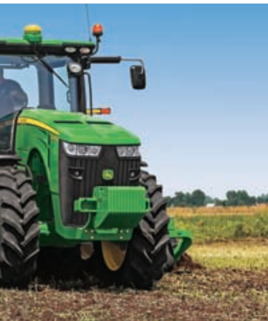
8370R : série 8R allant de 245 à 370 HP nominal au moteur +10 % boost/35 ch surpuissance active (moteur FT4, CommandCenter GS4TM, suspension de cabine active en option, pneus groupe 49 (2,15 m), éclairage LED en option, option de pompes hydrauliques allant jusqu'à 85 GPM).
