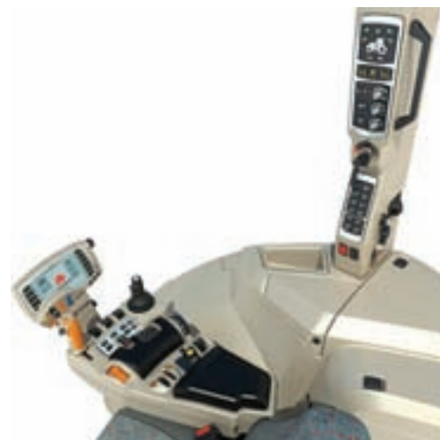
C'est à l'intérieur de la cabine qu'on retrouve le plus de changements avec un poste de conduite révisé. Celui-ci comporte un arrangement des boutons de commande amélioré et un nouveau joystick multifonctions ergonomique.
