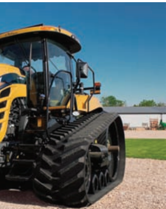
MT775E : moteur de 400 ch à double turbo en série offrant une réserve de couple de 42 %.
