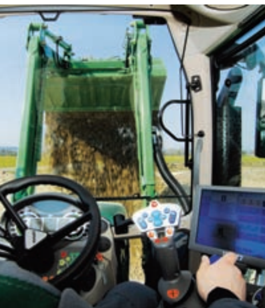
La cabine à cinq poteaux et à glace avant incurvée vers le toit offre une grande visibilité.
