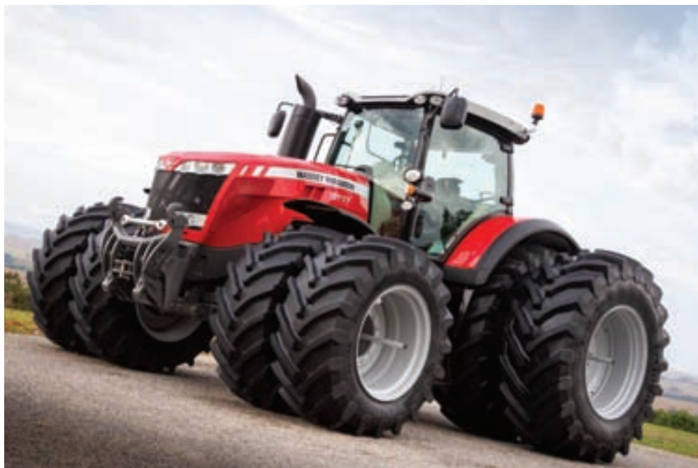
8737 : nouveau modèle Tier4 final offrant une puissance moteur jusqu'à 400 ch avec la gestion électronique de puissance pour les travaux de transport et de PDF. Transmission CVT de série et trois niveaux d'équipements. Terminal Datatronic 4 plus complet.
